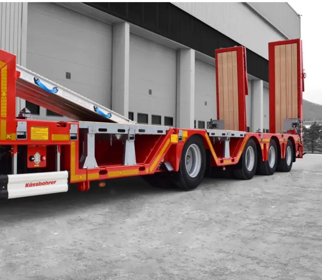
凯斯鲍尔可伸缩SLA R4型低平板挂车，配置2根BPW刚性悬架车轴和2根BPW随动转向车轴，承载能力达到58.35吨。
